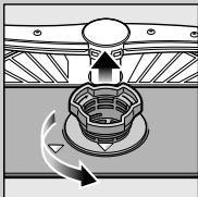
Odvrnuti cilindar sita, sistem sita izvaditi ...
