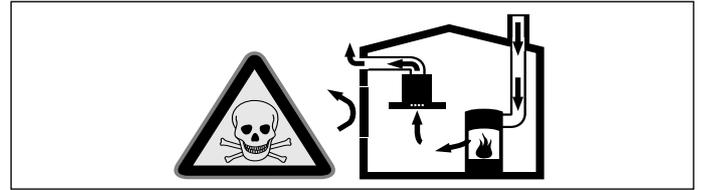
Hava dolaşimli ateşlikler (örneğin gaz, yağ, odun veya kömürle çalışan sobalar, şöfenler, su ısıtıcıları) yanma havasını kurulum yerinden alırlar ve atık gazı bir atık gaz sistemi (örneğin baca) kanalıyla dışarıya aktarırlar.
