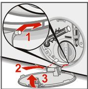
7. Service-Klappe einstecken (1), einrasten (2) und schließen (3).
