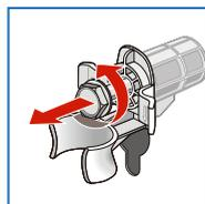
3. Alle 4 Transportsicherungsschrauben lösen und entfernen.
