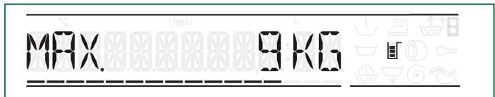
In Abhängigkeit von der eingefüllten Wäschemenge wird im Anzeigefeld eine Dosierempfehlung angezeigt.
