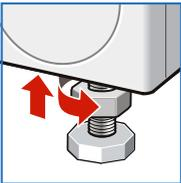
3. Kontermutter gegen das Gehäuse festziehen.
