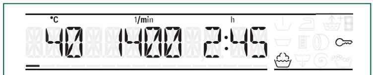
Die aktivierte Kindersicherung wird im Anzeigefeld durch das Symbol
