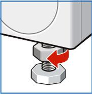
1. Kontermutter mit Schraubenschlüssel im Uhrzeigersinn lösen.
