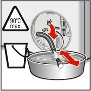
4. Entleerungsschlauch aus der Halterung nehmen.
