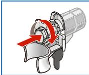
Netzleitung an den Halterungen festklemmen. Schrauben einsetzen und festziehen.
