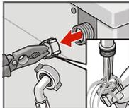
Sieb mit Zange herausnehmen und reinigen.
