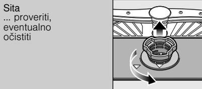
Odvrti cilindar sita, sistem sita izvaditi ...
