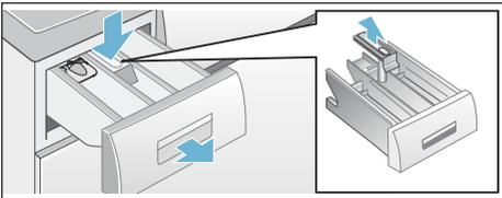
3. Einspülschale und Einsatz mit Wasser und Bürste reinigen und abtrocknen. Auch Wasch- und Weichspülmittelreste im Gehäuse entfernen.
