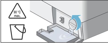
6. Pumpendeckel vorsichtig abschrauben, Restwasser kann auslaufen. Innenraum, Gewinde des Pumpendeckels und Pumpengehäuse reinigen. Das Flügelrad der Laugenpumpe muss sich drehen lassen.
