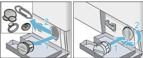
7. Service-Klappe einsetzen, einrasten und schließen.
