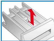
Waschmittelschublade offen lassen, damit Restwasser abtrocknen kann.
