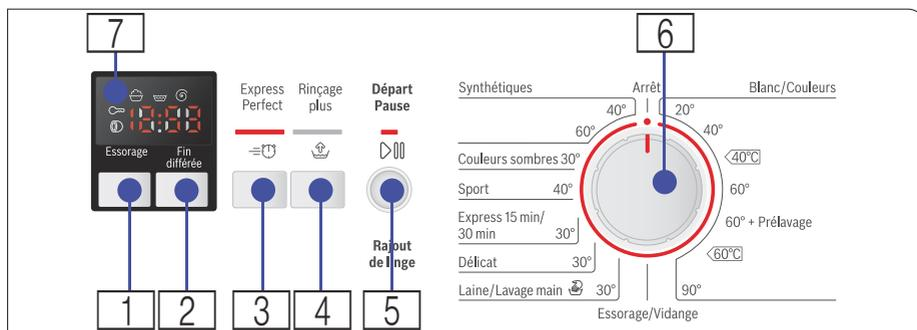
**1 2** **Essorage** et le temps **Fin différée** pour modifier les pré-réglages du programme
