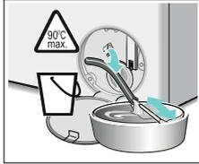
5. Retirez le volet obturateur, laissez le bain lessiviel s'écouler dans un récipient adéquat. Enfoncez le volet obturateur et mettez le flexible de vidange en place dans la fixation.
