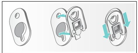
**Remarque :** Verrouillez fermement les couvercles en appuyant sur le crochet de crantage.
