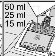
A mosogatószert csak a száraz mosogatószerkamrába töltsön be.
