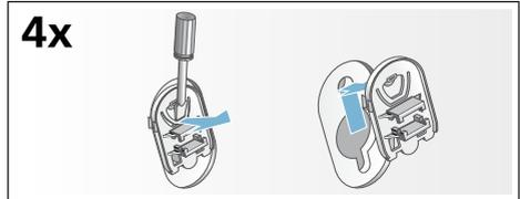
2. Enfoncez les 4 douilles. Bloquez le câble d'alimentation sur les supports. Introduisez les vis et serrez.
