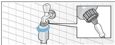
6. Nettoyez le filtre à l'arrière de l'appareil (pour Standard et Aqua-Secure): Retirez le tuyau de l'arrière de l'appareil. Sortez le filtre à l'aide d'une pince et nettoyez-le.
