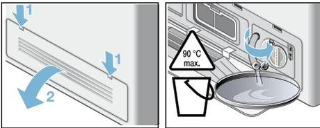
5. Retirez le couvercle, évacuez l'eau de lavage dans un réservoir approprié. Appuyez sur le couvercle et insérez le tuyau de vidange dans le support.
