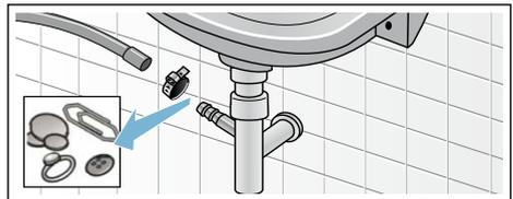
4. Rattachez le tuyau de vidange et sécurisez le point de raccordement avec le collier de serrage.
