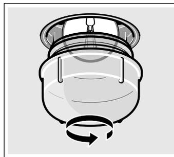
3. Lampe durch den gleichen Lampentyp ersetzen.
