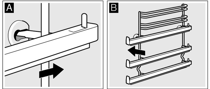
Die Gestelle passen nur rechts oder links. Achten Sie darauf, dass wie in Bild B Höhe 1 und 2 unten ist und Höhe 3, 4 und 5 oben. Die Auszugschienen müssen sich nach vorne herausziehen lassen.
