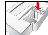
5. Vstavite kondenzacijsko posodo v ležišče, da zaslišite klik.
