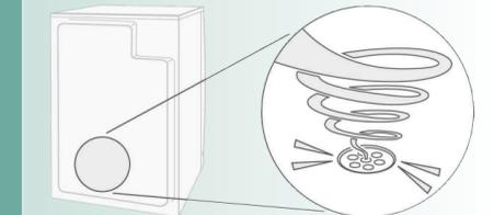
Pri črpanju kondenzirane vode v kondenzacijsko posodo se sliši črpanje.
