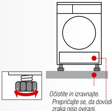
Očistite in izravnajte. Prepričajte se, da dovodi zraka niso ovirani.
