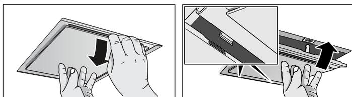
U přídavných filtrů ve vnitřním prostoru odjistěte aretaci a kovový tukový filtr vyklepte dolů. Při tom přidržete kovový tukový filtr zespodu druhou rukou.
