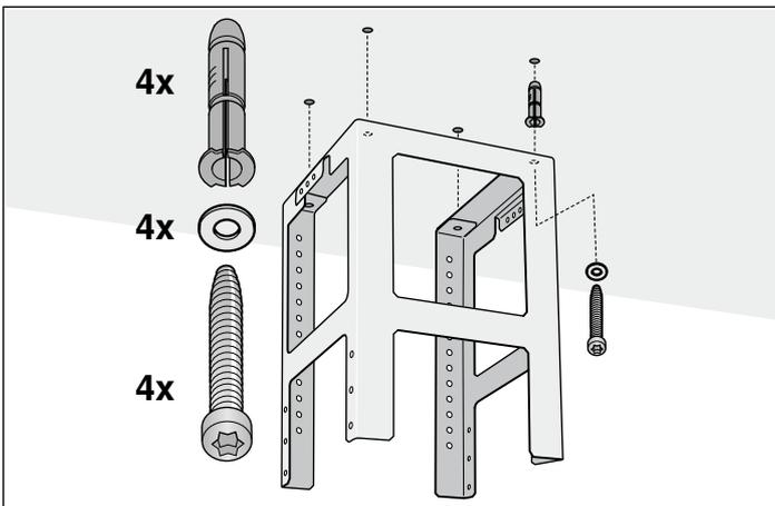
4. Pre upevnenie vyvrtajte štyri otvory s Ø 8 mm a hĺbkou otvoru 80 mm a zatlačte do nich hmoždinky až do úrovne steny.
