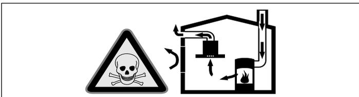
Ohniská závislé od vetrania miestnosti (napr. vyhrievacie prístroje na plyn, olej, drevo alebo uhlie, prietokové ohrievače, ohrievače vody) odoberajú dymové plyny z miestnosti, kde sú nainštalované a odvádzajú ich odsávacím zariadením (napr. komín) von.
