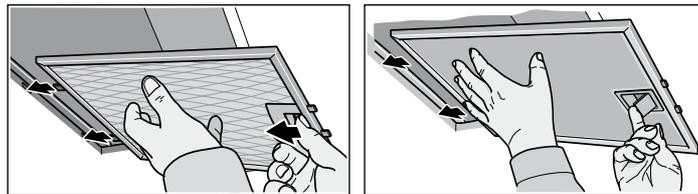
Ak ide o okrajové odsávacie filtre, tukový kovový filter potiahnite nadol. Pritom druhou rukou chyťte tukový kovový filter zdola.
