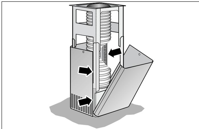
4. Horní část komínu posuňte nahoru a připevněte ji 2 šrouby.
