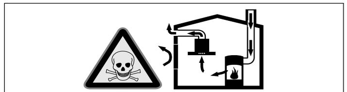
Ohniská závislé od vetrania miestnosti (napr. vyhrievacie prístroje na plyn, olej, drevo alebo uhlie, prietokové ohrievače, ohrievače vody) odoberajú dymové plyny z miestnosti, kde sú nainštalované a odvádzajú ich odsávacím zariadením (napr. komín) von.
