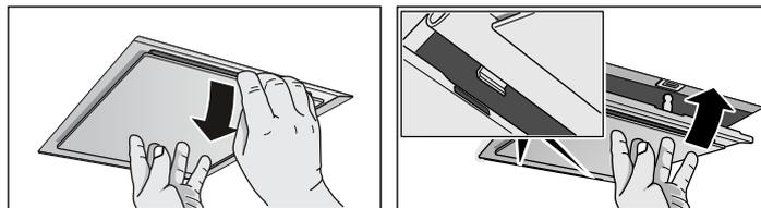
Ak ide o prídavné filtre vo vnútri, otvorte zabezpečovací mechanizmus a tukový kovový filter sklopte. Pritom druhou rukou chyťte tukový kovový filter zdola.
