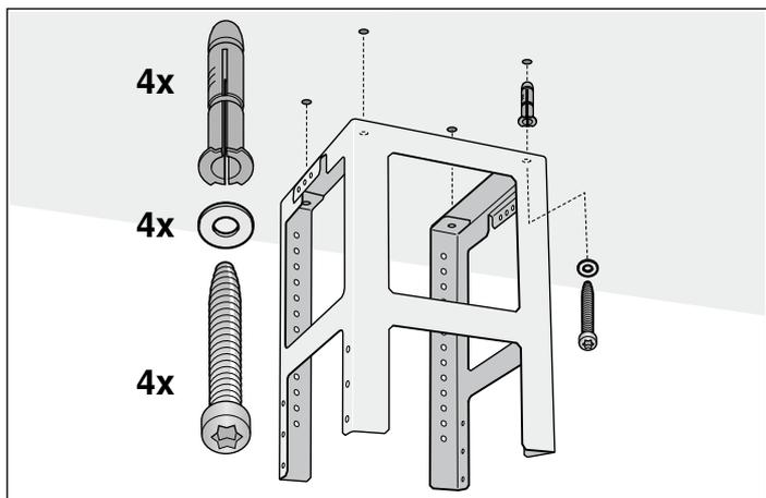
4. Pro upevnění vyvrtejte čtyři otvory o  $\varnothing$  8 mm a hloubce 80 mm a zatlačte do nich hmoždinky tak, aby byly v jedné rovině se stěnou.
