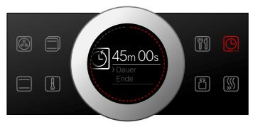
Nach wenigen Sekunden wird der Wert übernommen oder zweimal auf Feld [9] tippen. Im Display steht unter Betriebsart und Temperatur oder Stufe die Dauer
