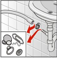
2. Schlauchschelle lösen, Ablaufschlauch vorsichtig abziehen.
