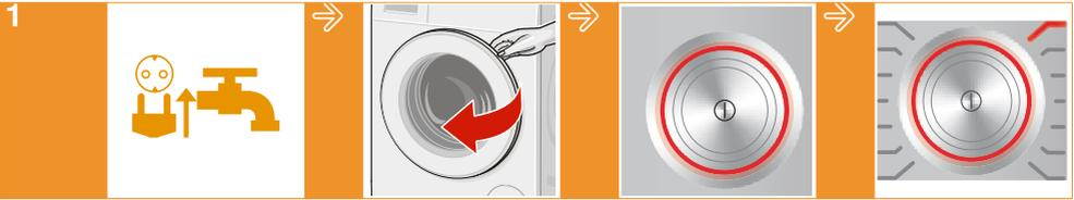
1 Netzstecker einstecken. Wasserhahn öffnen. Einfüllfenster öffnen. Zum Einschalten Taste ① drücken. Programm wählen z.B. **Baumwolle**.
