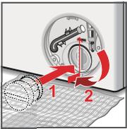
6. Pumpendeckel wieder einsetzen und verschrauben. Griff muss senkrecht stehen.
