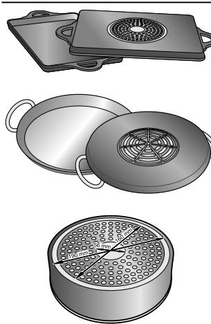
Lorsqu'on utilise de grands récipients de moindre surface ferromagnétique, seule la zone ferromagnétique se réchauffe, et la distribution de chaleur peut donc ne pas être homogène.
