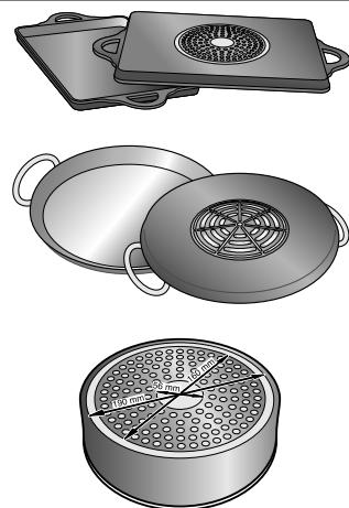
Ist der Boden des Kochgeschirrs nicht komplett ferromagnetisch, wird nur die magnetisierbare Fläche heiß. Dadurch kann es sein, dass die Wärme nicht gleichmäßig verteilt wird.
