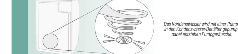
*Das Kondenswasser wird mit einer Pumpe in den Kondenswasser-Behälter gepumpt, dabei entstehen Pumpgeräusche.*
