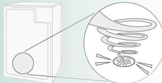
Das Kondenswasser wird mit einer Pumpe in den Kondenswasser-Behälter gepumpt, dabei entstehen Pumpgeräusche.
