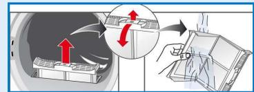
3. Flusen entfernen und beide Flusensiebe unter fließendem Wasser durchspülen und gut abtrocknen.
