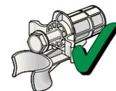
1. Retirar las mangueras (según el modelo) de las fijaciones y del codo. Extraer el codo.
