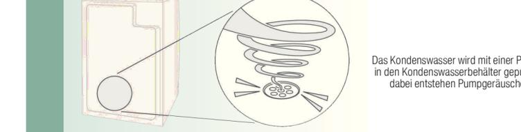
Das Kondenswasser wird mit einer Pumpe in den Kondenswasserbehälter gepumpt, dabei entstehen Pumpgeräusche.
