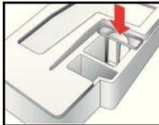
5. Kondenswasserbehälter einschieben bis zum Einrasten.
