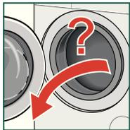
2. Prüfen, ob die Trommel vollständig entleert ist. Ggf. entleeren. Nur so ist eine fehlerfreie Funktion der Beladungsanzeige gewährleistet. → Seite 40
