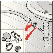
2. Schlauchschelle lösen, Ablaufschlauch vorsichtig abziehen.
