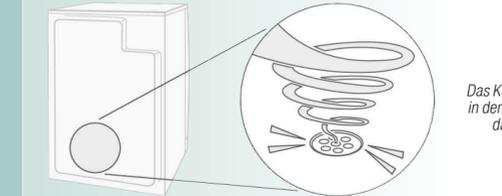
Das Kondenswasser wird mit einer Pumpe in den Kondenswasser-Behälter gepumpt, dabei entstehen Pumpgeräusche.
