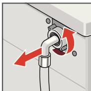
Retirez le flexible au dos de l'appareil.
