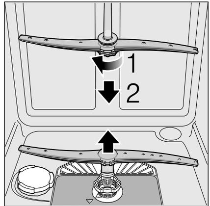
4. Sprüharme unter fließendem Wasser reinigen.
