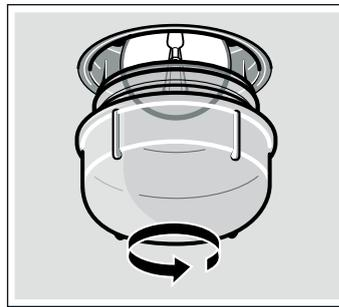
3. Lampe durch den gleichen Lampentyp ersetzen.
