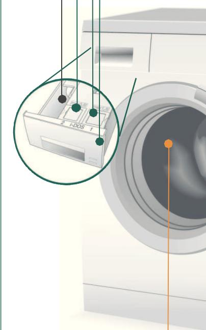
Trommelinnenbeleuchtung (je nach Modell) - nach Öffnen oder Schließen des Einfüllfensters, sowie nach Programmstart; erlischt selbsttätig.
