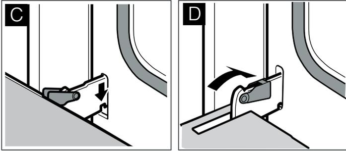
La porte de l'appareil est bloquée et ne pourra plus être décrochée.
