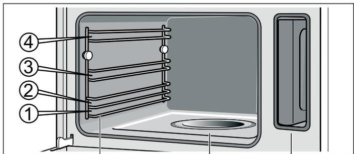
Supports pour les accessoires    Coupelle d'évaporation    Réservoir d'eau
