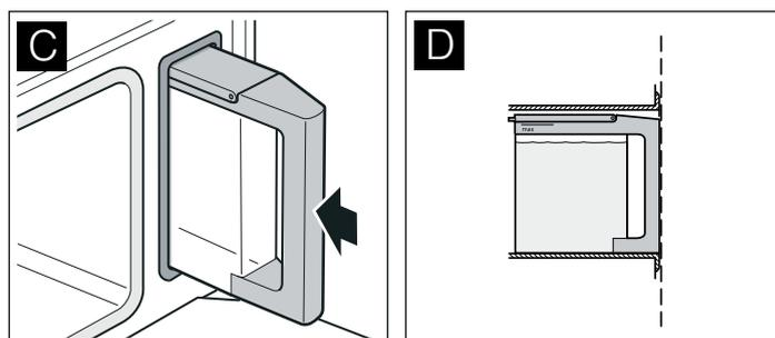
Le réservoir doit être au même niveau que son logement (fig. D).
