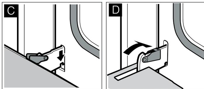
La porte de l'appareil est bloquée et ne pourra plus être décrochée.
