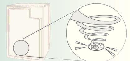
L'eau de condensation est évacuée par une pompe vers le réservoir d'eau de condensation, d'où des bruits de pompage.
