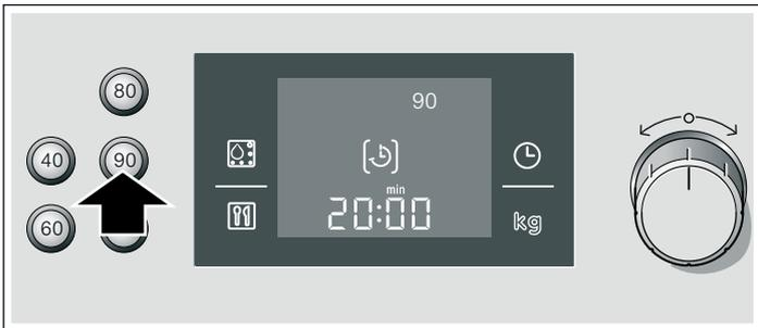
3. Drehwähler drehen, um eine Dauer einzustellen (max. 2 h).
