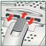
4. Zum Schließen beide Trommelklappen über die Trommelöffnung führen, die hintere über die vordere Klappe, dann beide leicht nach unten drücken, bis der Schließmechanismus einrastet.
