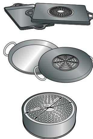
Bei großen Kochgefäßen mit einer im Durchmesser kleineren ferromagnetischen Fläche, wird nur diese ferromagnetische Fläche heiß. Es ist also möglich, dass die Wärmeverteilung hier nicht gleichmäßig erfolgt.
