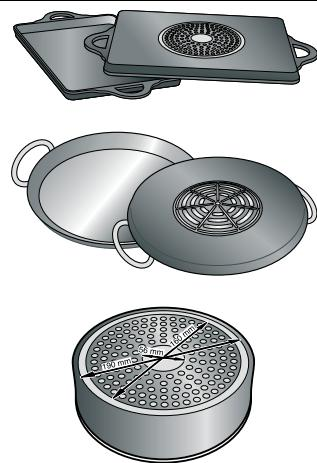
Se si utilizzano grandi recipienti con un'area ferromagnetica di diametro inferiore, si riscalda soltanto la zona ferromagnetica, per cui la distribuzione del calore potrebbe non essere omogenea. I recipienti con parti di alluminio inserite nella base, riducono l'area ferromagnetica e, pertanto, il calore fornito può essere inferiore o possono verificarsi problemi di rilevamento.
