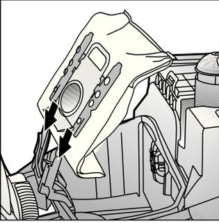
Työnnä uusi suodatinpussi rajoittimeen asti pitimessä.
