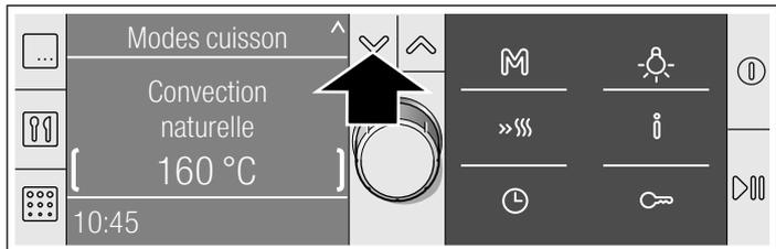
3. Au moyen du sélecteur rotatif, régler la température désirée.
