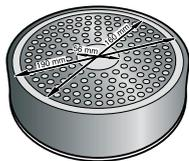
För att uppnå goda kokresultat, rekommenderas det att kärlets ferromagnetiska diameter ska anpassas till kokzonens storlek. Om kärlet inte har detekterat någon kokzon, kontrollera det på en zon med en lite mindre diameter.
