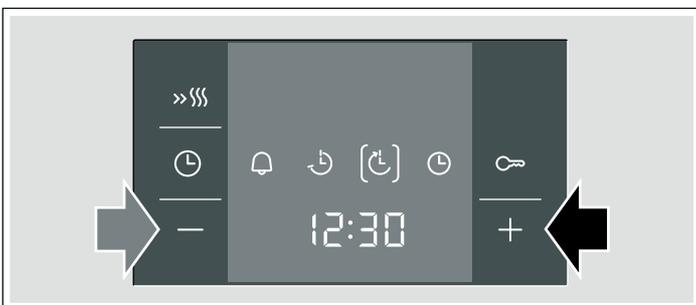
Nach wenigen Sekunden übernimmt der Backofen die Einstellungen und schaltet in Warteposition. In der Anzeige steht die Uhrzeit, zu der das Gericht fertig ist, und das Symbol **⌚** steht in Klammern. Symbol **🔔** und **⌚** erlöschen. Wenn der Backofen startet, läuft die Dauer sichtbar ab und das Symbol **⏪** steht in Klammern. Das Symbol **⌚** erlischt.
