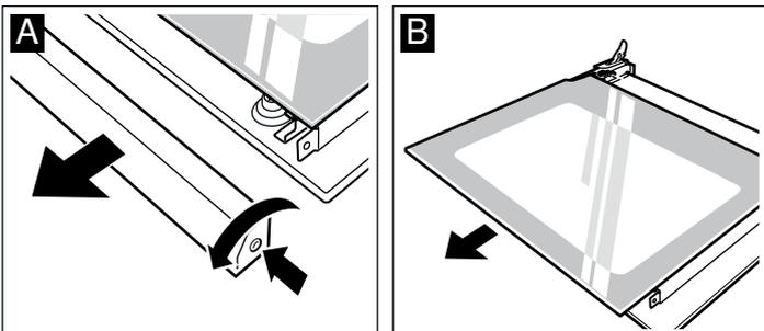
4. Halteklammern rechts und links aufschrauben. Scheibe anheben und Halterungen von der Scheibe abziehen (Bild C). Scheibe herausnehmen.
