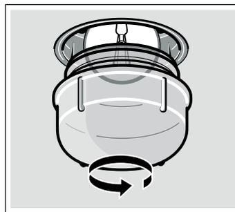
3. Lampe durch den gleichen Lampentyp ersetzen.
