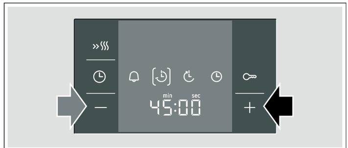
Nach wenigen Sekunden startet der Backofen. In der Anzeige läuft die Dauer sichtbar ab und das Symbol [
