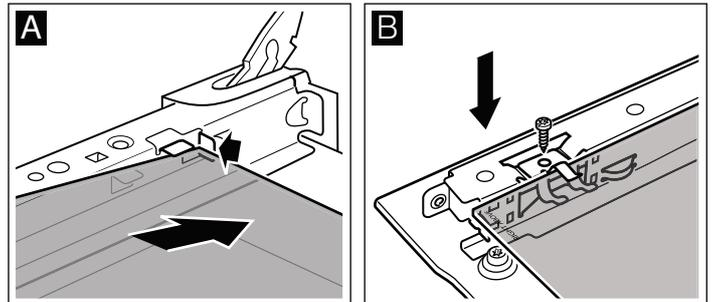
3. Oberste Scheibe schräg nach hinten einschieben. Die glatte Fläche muss außen sein.
