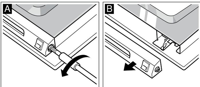
Veillez à ce que la porte du four ne se referme pas pendant que le cache est démonté. La plaque en verre intérieure pourrait se détériorer.
