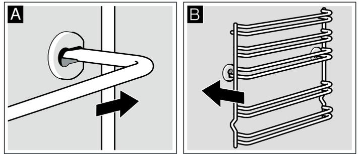
Les clayettes ou les rails peuvent être ajustés à gauche et à droite. La courbure doit toujours être orientée vers le bas.
