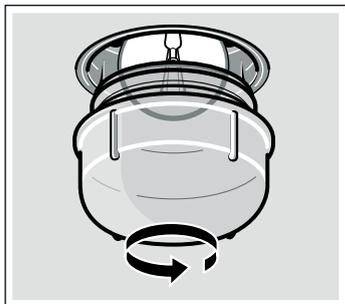
3. Remplacez l'ampoule par un modèle similaire.
