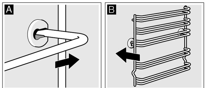
Die Gestelle passen rechts und links. Achten Sie darauf, dass wie in Bild B Höhe 1 und 2 unten ist und Höhe 3, 4 und 5 oben.
