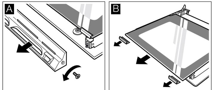
4. Halteklammern rechts und links aufschrauben. Scheibe anheben und beide Klammern von der Scheibe abnehmen (Bild C). Scheibe herausziehen.
