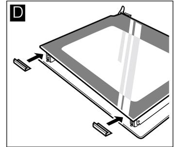
5. Abdeckung aufsetzen und anschrauben.
