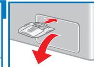
2. Wasserrinne ausklappen und Behälter mit ausreichendem Fassungsvermögen unterstellen.
