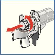
3. Alle 4 Transportsicherungsschrauben lösen und entfernen.
