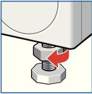
1. Kontermutter mit Schraubenschlüssel im Uhrzeigersinn lösen.
