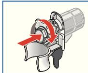
Netzleitung an den Halterungen festklemmen. Schrauben einsetzen und festziehen.
