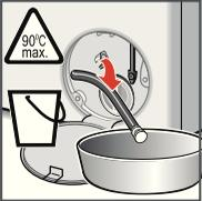
4. Verschluss-Kappe abziehen, Lauge in geeignetes Gefäß abfließen lassen.
