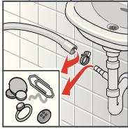
2. Schlauchschelle lösen, Ablaufschlauch vorsichtig abziehen.
