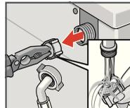
Sieb mit Zange herausnehmen und reinigen.
