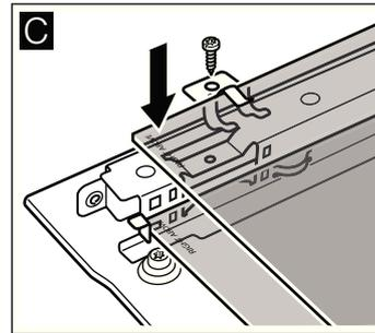
4. Oberste Scheibe schräg nach hinten einschieben. Die glatte Fläche muss außen sein.
