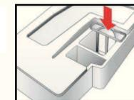
5. Kondenswasserbehälter einschieben bis zum Einrasten.
