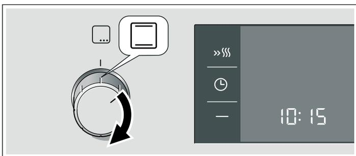
2. A l'aide du thermostat, régler la température ou la position grill.
