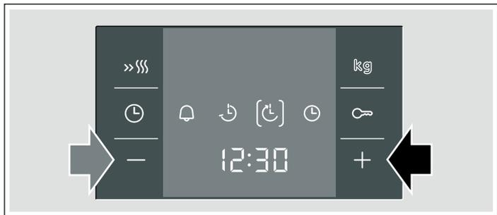
Après quelques secondes, le four valide les réglages et se met en position d'attente. L'affichage indique l'heure à laquelle le mets sera prêt et le symbole **⌚** figure entre parenthèses. Le symbole **⏸** et **⏱** s'éteignent. Lorsque le four démarre, la durée s'écoule visiblement et le symbole **⏱** figure entre parenthèses. Le symbole **⌚** s'éteint.
