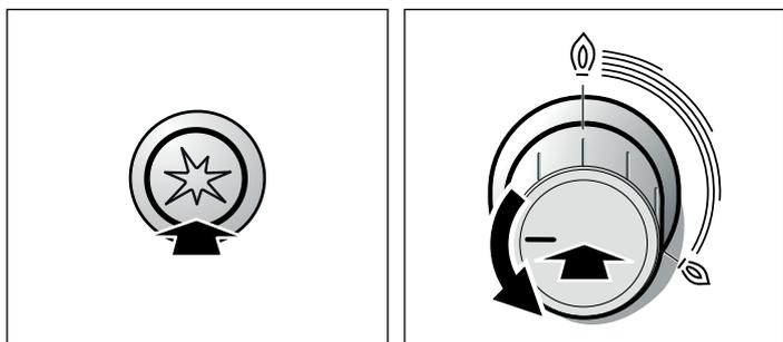
4. Tenere premuto il selettore della zona di cottura per circa 1-3 secondi. Il dispositivo di sicurezza per l'accensione verrà attivato. Se la fiamma si spegne, l'alimentazione di gas viene automaticamente interrotta dal sistema di sicurezza per l'accensione.
