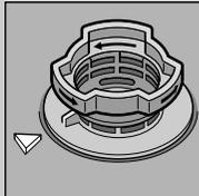
Avvitare il sistema di filtraggio. **RISPETTARE IL RIFERIMENTO!**
