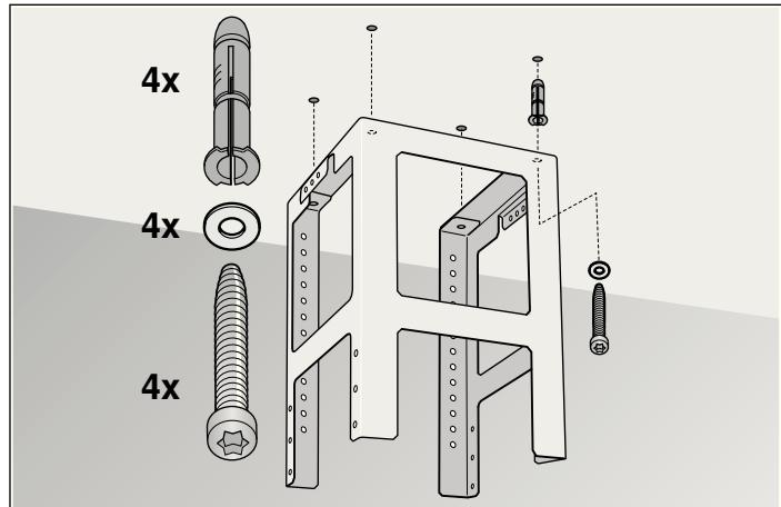
4. Furar quatro furos com Ø 8 mm e profundidade de furo de 80 mm para a fixação e introduzir as buchas alinhadas à face.
