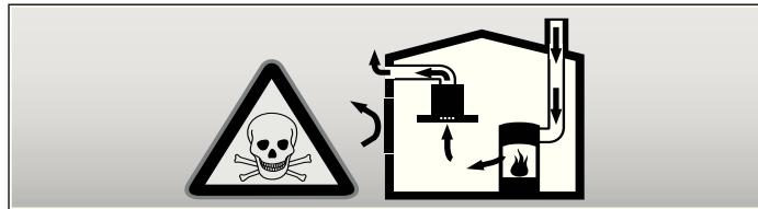
Equipamentos de aquecimento que dependem do ar ambiente (p.ex. sistemas de aquecimento a gás, óleo, lenha ou carvão, esquentadores, cilindros) utilizam o ar do espaço de montagem na combustão e transportam os gases de combustão para o exterior através do sistema de saída de gases de uma unidade de combustão (p.ex. uma chaminé).
