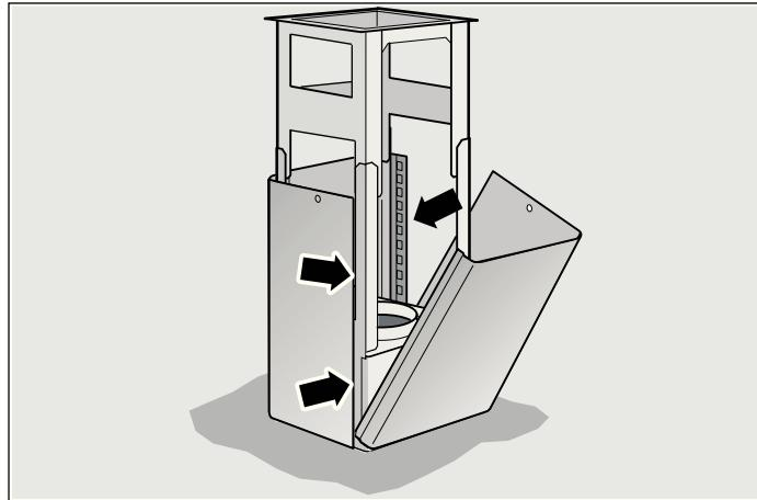
4. Deslizar hacia arriba la parte superior de la chimenea y fijarla con dos tornillos.
