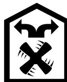
Liesituulettimen imemä ilma palautetaan rasvasuodattimien ja aktiivihiihlsuodattimen puhdistamana takaisin keittiöön.
