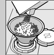
Spezialsalz einfüllen (nie Reiniger einfüllen!).
