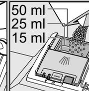
Reiniger nur in trockene Reinigerkammer einfüllen.
