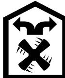
Liesituulettimen imemä ilma palautetaan rasvasuodattimien ja aktiivihilisuodattimien puhdistamana takaisin keittiöön.
