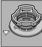
Avvitare il sistema di filtraggio. **RISPETTARE IL RIFERIMENTO!**
