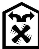
Die angesaugte Luft wird durch die Fettfilter und einen Aktivkohlefilter gereinigt und wieder in die Küche zurückgeführt.
