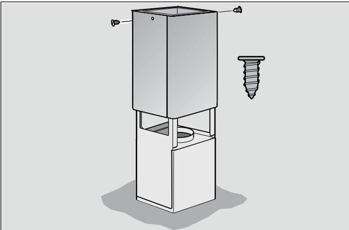
5. Beide untere Teile des Kamins einsetzen und zusammenstecken.
