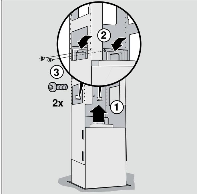
3. Sicherungsbügel einhängen und festschrauben.
