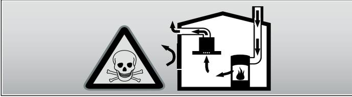
Raumluftabhängige Feuerstätten (z.B. gas-, öl-, holz- oder kohlebetriebene Heizgeräte, Durchlauferhitzer, Warmwasserbereiter) beziehen Verbrennungsluft aus dem Aufstellraum und führen die Abgase durch eine Abgasanlage (z.B. Kamin) ins Freie.
